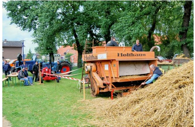
Der Dreschkasten wurde von einem alten Lanz-Traktor angetrieben
